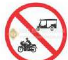
ป.26 ป้ายห้ามรถจักรยานยนต์ และรถยนต์สามล้อผ่าน
